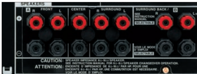
Wer trotz einer solchen Aufschrift an seinen Receiver Lautsprecher mit vier Ohm statt wie vorgesehen acht Ohm Nennimpedanz anschließt, kann mit einer erheblichen Steigerung der Ausgangsleistung rechnen.
