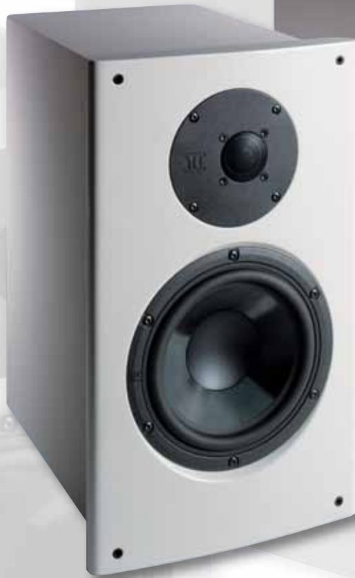
Die als „Klangsegel“ ausgeführte Frontplatte verhindert störende Kantendispersionen im Mittel- und Hochtonbereich
