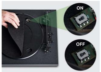
Schalterstellung bei Anschluss an einen Verstärker **ohne** integrierten Phono-Vorverstärker.
