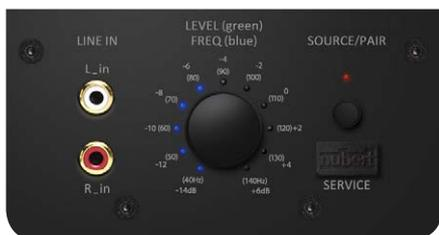
**Trennfrequenz und Pegel können alternativ über den Kombi-Drehregler am Aktivmodul eingestellt werden**
