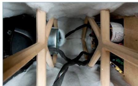
**Sauber versteift:** Das 33cm-Langhubchassis sitzt im stabilen, mit Streben verstärkten 60-Liter-Gehäuse. Eines der beiden Bassreflexrohre lässt sich je nach Einsatzzweck per mitgeliefertem Stopfen verschließen.
