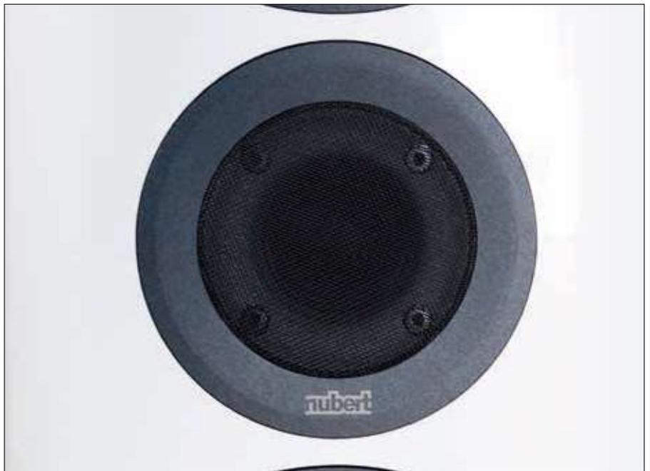
Der Hochtöner kommt auf einen Durchmesser von 26 Millimeter und verwendet eine Teterongewebekalotte. Bei  $-3\text{ dB}$  spielt er bis 22 000 Hertz auf
