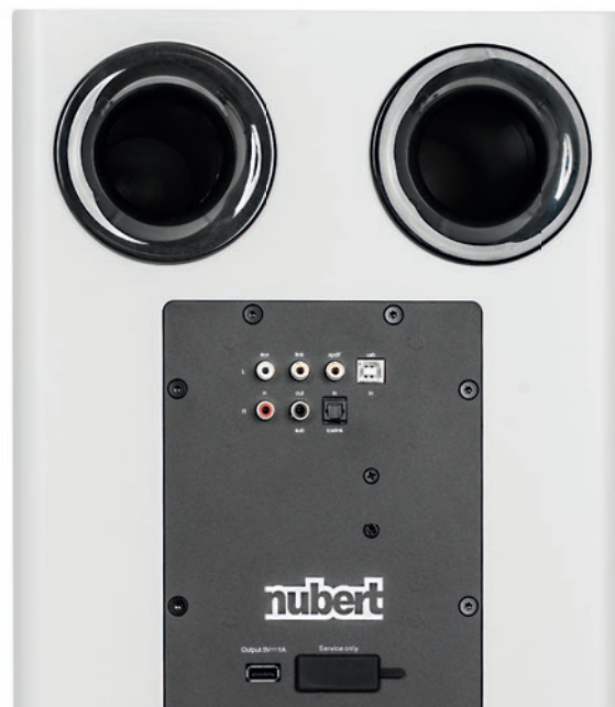
Das Anschlussfeld der nuPro A-600 verzichtet zwar auf XLR-Eingänge, bietet ansonsten aber viele Möglichkeiten, von analog, über S/PDIF und USB. Der USB-A-Anschluss unten dient zum Aufladen eines Smartphones oder dergleichen. Hinter der Gummikappe sitzt ein Serviceanschluss.
